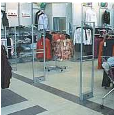
Warensicherungsanlagen erzeugen nicht nur im Durchgangsbereich vergleichsweise starke Felder, sondern außerdem auch Streufelder in der Umgebung.
